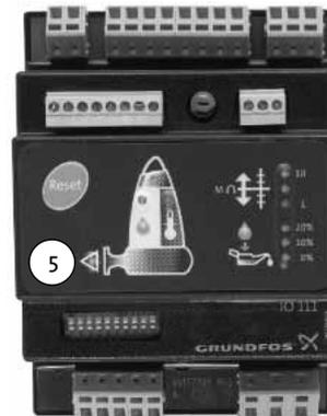
Die Sensorüberwachung der Abwasserpumpen SE bildet zusammen mit der Auswerteeinheit IO111 ein Frühwarnsystem mit genauer Fehlerlokalisierung. Analog- und Digitalsensoren überprüfen wichtige Parameter wie Temperatur, Isolationsfehler, Feuchtigkeit im Motor und Ölsperkkammer. Dies hilft geeignete Maßnahmen rechtzeitig zu ergreifen und somit Kosten und Zeit zu sparen.
