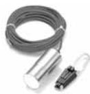
Ultraschallsensor mit Aufhängung und 10 m Kabel. Der Sensor arbeitet berührungslos über der Messflüssigkeit hängend. Der Flüssigkeitsstand wird über die Laufzeit des Ultraschallsignals bestimmt.
