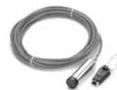
Hydrostatischer Druckaufnehmer mit Aufhängung und 10 m Kabel. Der Sensor arbeitet untergetaucht in der Messflüssigkeit. Ein integrierter Piezokristall verändert die elektrische Spannung bei Änderung des Flüssigkeitsstandes.
