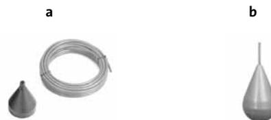
a) Offene Messglocke als separater Hochwasser-ALARM mit erneutem Einschaltbefehl der installierten Pumpen. Das Wirkprinzip ist analog zum geschlossenen Messbalg über Staudruck. Ausschaltpunkt über Niveau oder bei Ausfall des eigentlichen Niveausensors über eine einstellbare Laufzeitbegrenzung der Pumpen.
