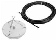
Geschlossene Messglocke mit Aufhängung und 10 m Pneumatikschlauch. Der Sensor arbeitet untergetaucht in der Messflüssigkeit nach dem Staudruckverfahren. Ein mit Luft gefüllter Messbalg aus Perbunan wird über den steigenden Flüssigkeitsstand komprimiert und schaltet einen Druckschalter im Steuergerät.
