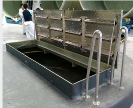
Abb. 12 Große vorgefertigte Pumpstationen in der Fabrik und bereit für die Montage von Leitungen, Ventilen usw. für vier tauchbare Abwasserpumpen
