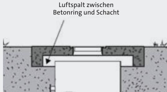
Abb. 17 Für Verkehrsflächen zugelassene Abdeckung mit Luftspalt
