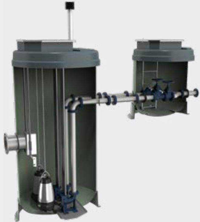
Abb. 22 Pumpstation mit zwei Tauchmotorpumpen auf einem Kupplungsfußkrümmer-Satz Mit VC-Rohrsystem und Ventilkammer
