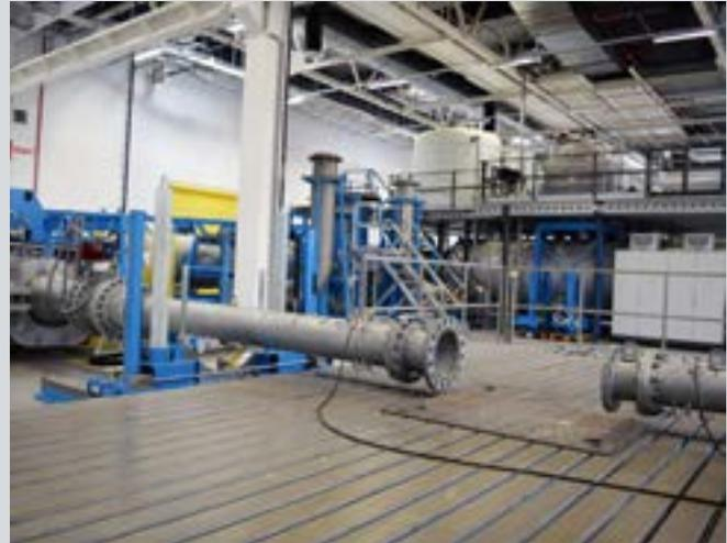
Abb. 5 Vibrationstest einer Pumpe mit horizontal geteiltem Gehäuse (nicht verwendbar für tauchbare Abwasserpumpen)
