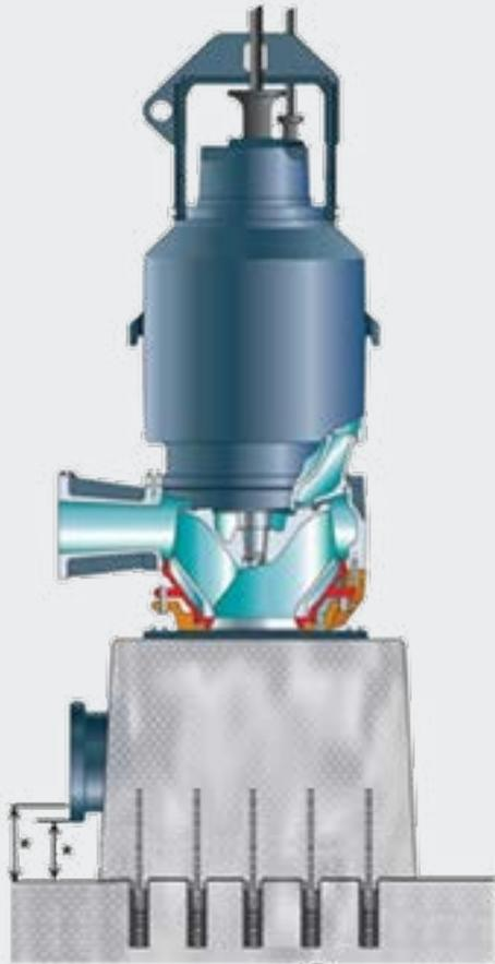
Abb. 14 Vertikale tauchbare Grundfos Trockenschacht-Klärwasserpumpe auf Betonfundament mit Lagernägeln im Boden
