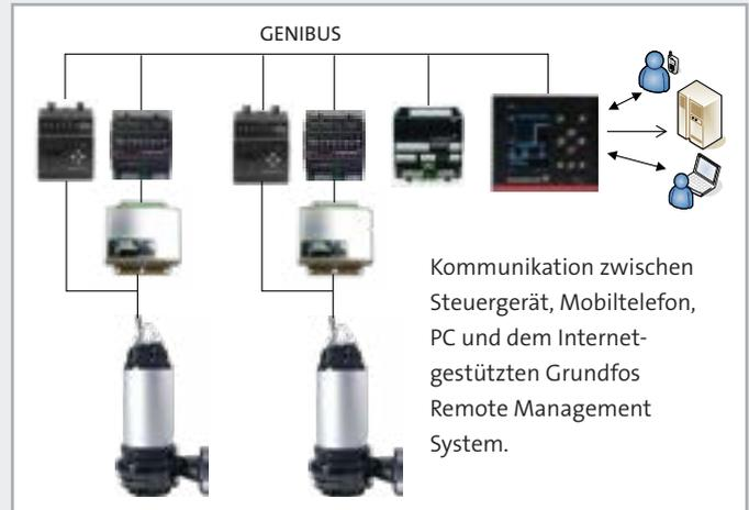
Abb. 13. Vollständige Systemübersicht mit Grundfos Steuermodulen für SL-, SE- und S-Pumpen in der Sensor-Ausführung mit Motoren von 9 bis 520 kW.
