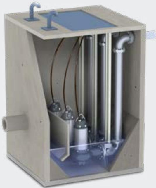
Abb. 4 Quadratische Pumpstation aus Beton mit Prallblech vor dem Zulauf und drei tauchbaren Abwasserpumpen auf dem eigentlichen Fußkrümmer zur Montage des Kupplungsfußkrümmer-Satzes auf einem Betonsockel.
