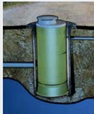
Abb. 42 Alte Betonpumpstation mit einer neuen vorgefertigten Einschub-Pumpstation
