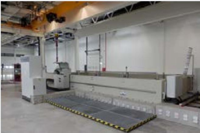
Abb. 2 Prüfstand für tauchbare Klärwasserpumpen
