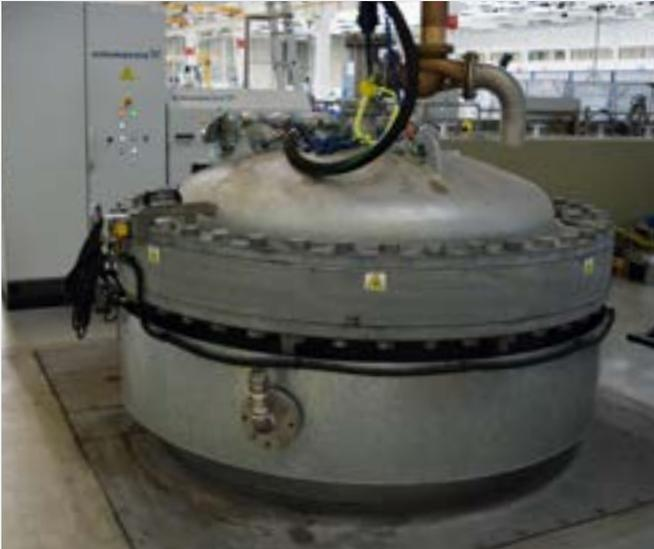
Abb. 4 Schacht zum Testen von Axial-Tauchpumpen der Typen KPL und KWM
