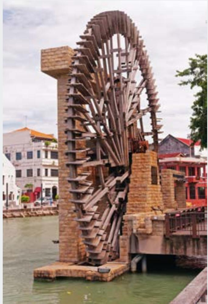
Abb. 3 Ein Wasserrad ist eine Maschine, die die Energie von frei fließendem oder fallendem Wasser in nutzbare Energieformen umwandelt. Ein gängiges Beispiel hierfür ist eine Wassermühle. Ein Wasserrad besteht aus einem großen Rad aus Holz oder Metall mit einer Reihe von Schaufeln oder Gefäßen am äußeren Rand, die die Treibfläche bilden.
