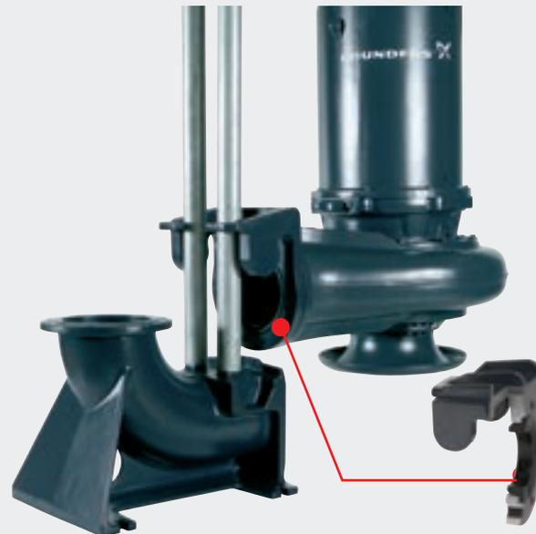
Abb. 5 Grundfos SmartSeal-System mit Profildichtung aus Gummi, die zwischen dem Druckflansch der Pumpe und dem Flansch der Führungsklaue befestigt ist
