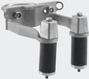
Abb. 9 Mittlerer Führungsrohrbügel; erforderlich für Führungsrohre von mehr als 6 m Länge. Der mittlere Führungsrohrbügel wird mithilfe von Edelstahlklemmen am Druckrohr montiert.
