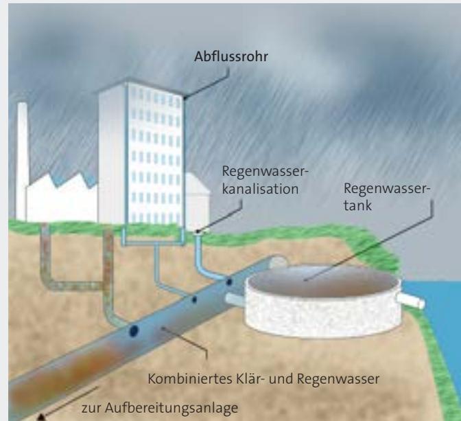
Abb. 9 Kombinierte Kanalisationssysteme mit integriertem Trockenbecken (Regenwassertank) bei nassem Wetter
