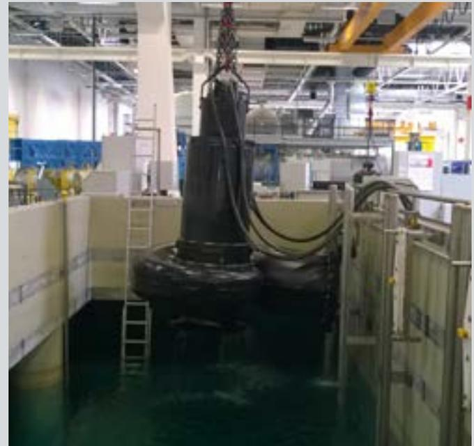
Abb. 3 Klärwasser-Tauchpumpe der S-Baureihe zur Installation auf Kupplungsfußkrümmer im Prüfstand
