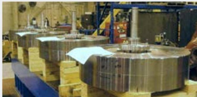
Abb. 8 Schwungräder für eine Pumpstation in den USA Durchmesser des Schwungrads 864 mm, Höhe 247 mm und Trägheitsmoment  $106 \text{ kg}\cdot\text{m}^2$
