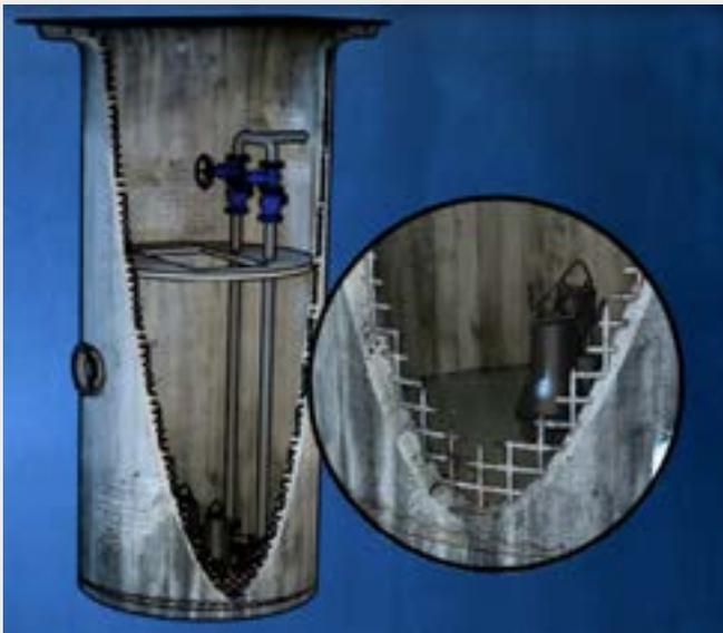
Abb. 40 Alte Pumpstation, bei der der Beton in schlechtem Zustand ist, was die Gefahr des Austretens von Abwasser nach sich zieht
