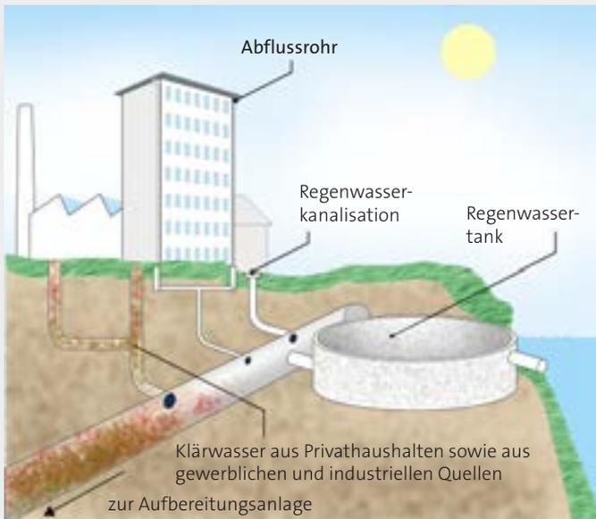
Abb. 8 Kombinierte Kanalisationssysteme mit integriertem Trockenbecken (Regenwassertank) bei trockenem Wetter
