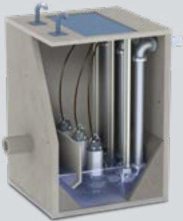
Abb. 9 Rechteckige Pumpstation aus Beton mit Prallblech vor dem Zulauf und drei tauchbaren Abwasserpumpen sowie mit dem eigentlichen Fußkrümmer des Kupplungsfußkrümmer-Satzes auf einem Betonsockel
