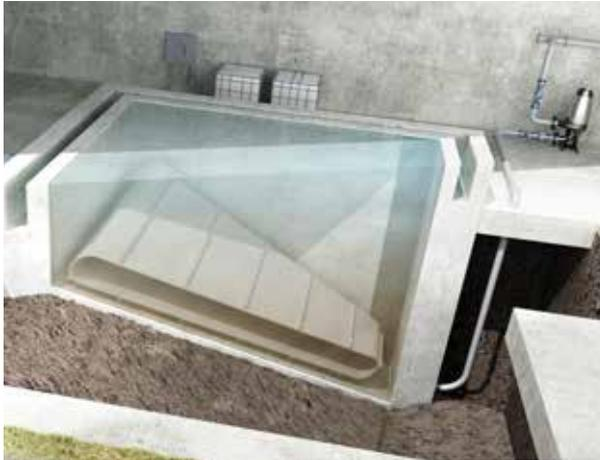
Sedimentation ist ein physikalisches Wasseraufbereitungsverfahren, bei dem sich im Wasser gelöste Feststoffe unter Einwirkung der Schwerkraft absetzen. Für eine ordnungsgemäße Sedimentation sind gleichmäßige Strömungsverhältnisse erforderlich. Dabei darf das Sediment nicht mit empfindlichen Pumpenbauteilen in Kontakt kommen, um einen erhöhten Verschleiß zu vermeiden.
