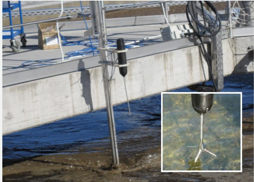
Abb. 33 Messen der Strömungsgeschwindigkeit im Klärwerk unter realen Größenverhältnissen
