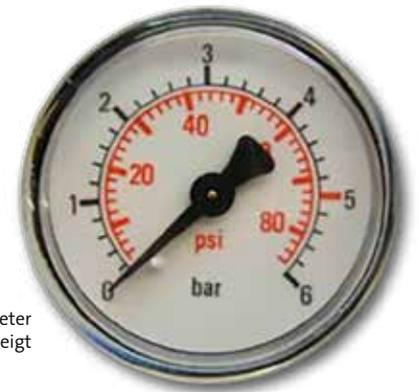
Bei 50 m<sup>3</sup>/h wird etwa 16,5 Meter Förderhöhe angezeigt
