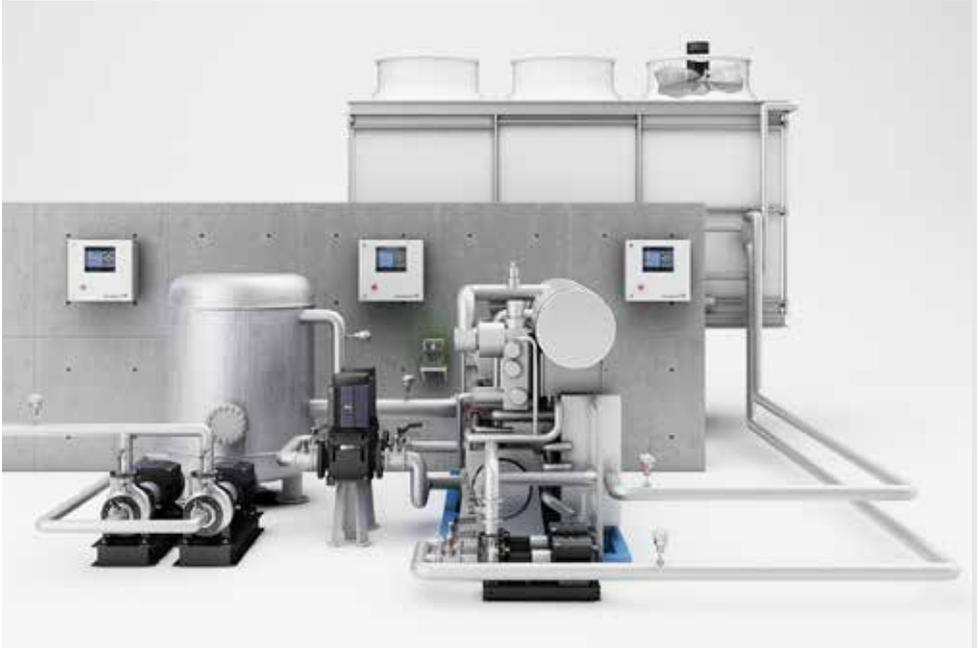
Abb. 1 zeigt den Verdichter (Mitte), in dem der Kälteprozess stattfindet. Links neben dem Verdichter befinden sich vier Pumpen, die das Kühlmedium in die Produktion leiten. Vor dem Verdichter sind zwei weitere Pumpen montiert, die das erwärmte Medium in die Kühltürme transportieren (hinten). An der Wand angebracht sind die Schaltschränke und die Dosierpumpen, die das Kühlwasser aufbereiten.
