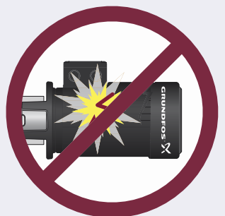
Abb. 1.4.6: Funkenfreie Motoren Ex nA erzeugen unter normalen Bedingungen keine Zündfunken.
