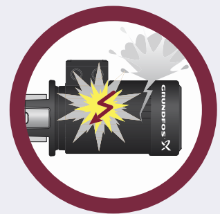
Abb. 1.4.4: Die Explosion findet im Motor statt und wird über die Flammenwege nach außen geleitet. Die Temperaturklassen für druckfest gekapselte EExd-Motoren gelten für Außenflächen.
