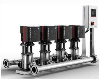
Der Wasserbedarf der Brauerei schwankt in der Regel. Dies erfordert den Einsatz von drehzahlverstellbaren Druckerhöhungsanlagen (DEA) mit in Reihe geschalteten Hochdruckpumpen der Baureihe CR.
