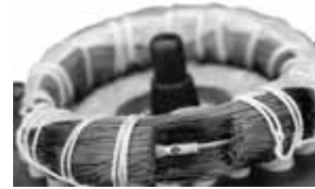
Abb. 21 PTC-Fühler eingebaut in die Wicklungen
