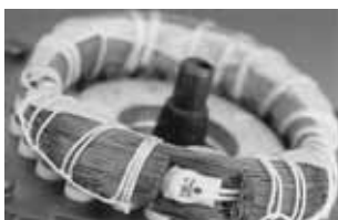
Abb. 23 Thermoschalter eingebaut in die Wicklungen
