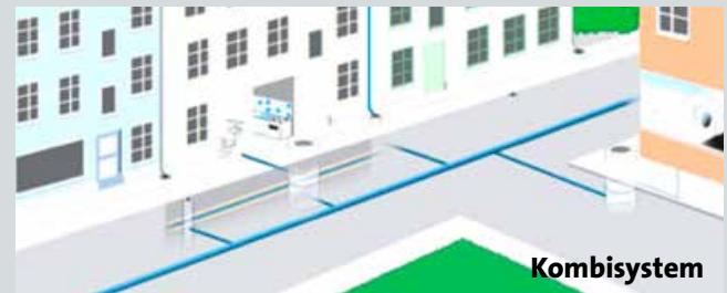
Abb. 4 Kombisystem für Klärwasser, Schmutzwasser und Regenwasser
