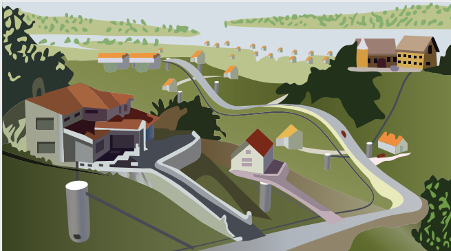
Abb. 2 Druckentwässerungssystem mit Schneidwerkpumpen in einem entlegenen Gebiet mit wellenförmigen Gelände
