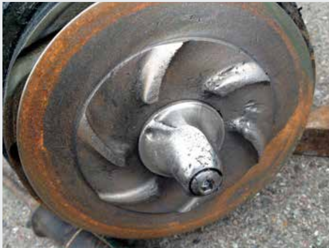
Abb. 11 Schneidwerkpumpe mit Schneidwerk und Laufrad nach einem Jahr Betrieb in einer Anwendung mit Sandproblemen
