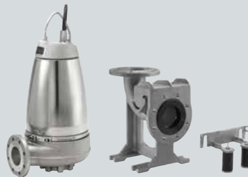
Abb. 15 Für höhere Flussmengen von hoch korrodierenden Medien ist eine vollständig aus Edelstahl bestehende Klärwasser-Tauchpumpe und ein Kupplungsfußkrümmer mit Führungsrohren aus Edelstahl und einem oberen Klappmechanismus für das Führungsrohr die richtige Wahl
