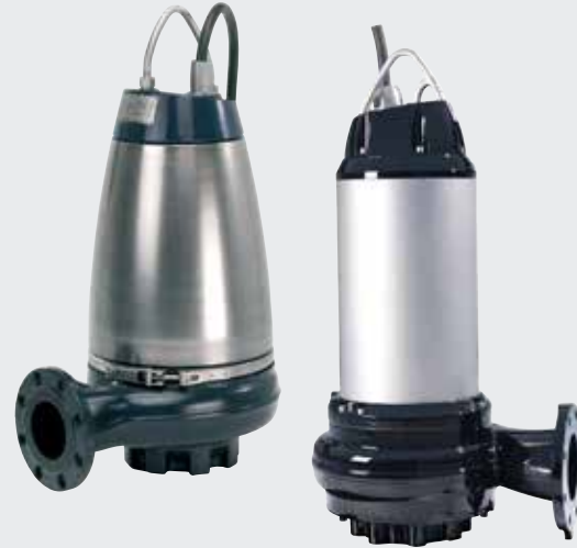
Abb. 2 Tauchbare Grundfos SE-Pumpen mit Motormantel und Kühlanlage können durchgängig betrieben werden, wenn der Flüssigkeitsstand lediglich oberhalb des Pumpengehäuses liegt
