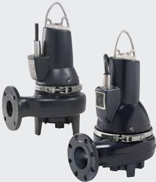
Abb. 1 Tauchbare Grundfos SL-Pumpen und andere kleinere Gusseisenpumpen ohne Kühlanlage können mit einem Flüssigkeitsstand bis zur Motoroberseite durchgängig betrieben werden
