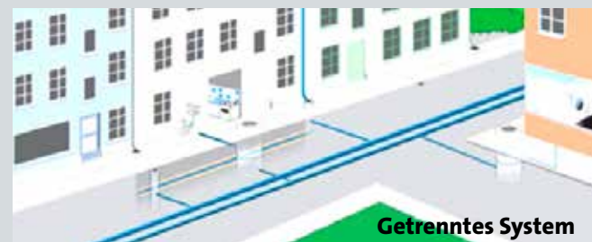
Abb. 5 Getrenntes System, bei dem Regenwasser über eine eigene Abflussleitung abgeleitet wird und Schmutz- sowie Klärwasser über eine andere Abflussleitung
