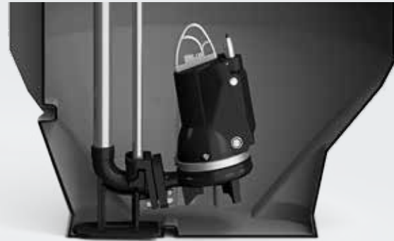
Abb. 5 Mit der Mutter am Boden des Sammelbrunnens wird der Kupplungsfußkrümmer in der richtigen Position gehalten, ohne dauerhaft am Boden des Sammelbrunnens befestigt zu sein
