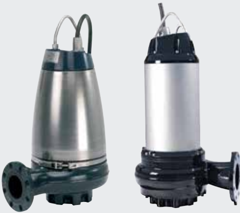
Abb. 25 SE1- und SEV- Pumpen mit S-tube®- oder SuperVortex-Laufrad Typische Pumpen für den Transport unbehandelten Abwassers mit Toilettenabfällen aus Gewerbegebäuden und kleinen kommunalen Pumpstationen.
