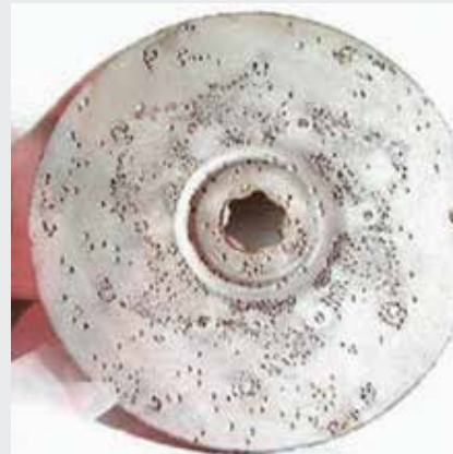
Abb. 5 Typische Grübchenbildung durch Kavitation auf der Laufradrückseite
