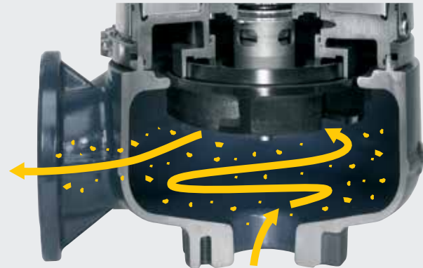
Abb. 8 Grundfos SuperVortex -Pumpe mit freiem Durchgang von 100 mm im Pumpengehäuse. Keine Flüssigkeiten oder Festkörper passieren das Laufrad.
