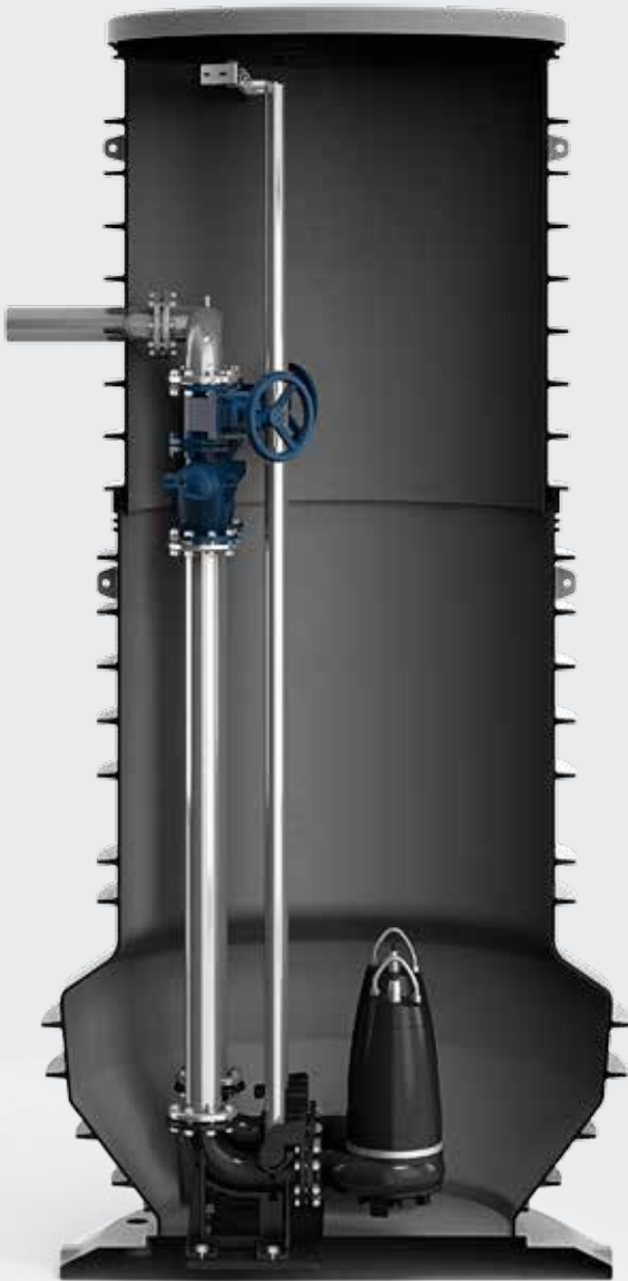
Abb. 7 Pumpstationen für Installationen mit zwei Klärwasser-Tauchpumpen auf einem Kupplungsfußkrümmer-Satz Sammelbrunnen-Durchmesser von 1700 mm und Durchmesser des Hauptabschnitts von 1400 mm. Gesamtlänge von 2000 mm - 6000 mm
