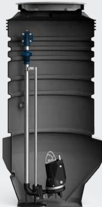
Abb. 4 Pumpstation für die Einzelinstallation einer tauchbaren SEG AUTOADAPT-Schneidwerkpumpe auf einem Kupplungsfußkrümmer-Satz Sammelbrunnen-Durchmesser von 800 mm und Durchmesser des Hauptabschnitts von 600 mm
