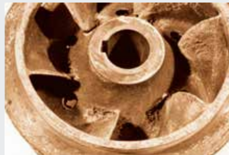
Abb. 6 Typische Kavitation am Zulauf zum Laufrad
