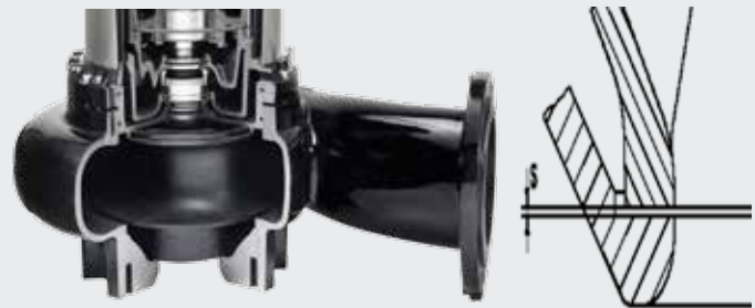
Abb. 5 Dichtspalt in Grundfos Pumpen mit SmartTrim
