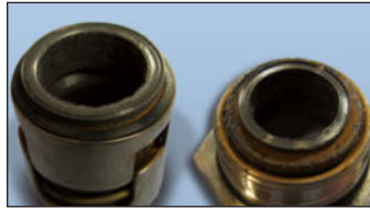
Abb. 5.12: Tiefe Riefen auf der Dichtfläche im Bereich der medienbeaufschlagten Seite
