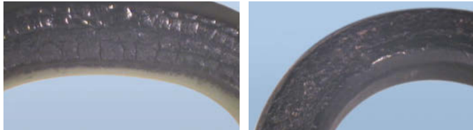
Abb. 5.3: Beschädigung der Oberfläche von Bauteilen aus EPDM und FKM durch zu hohe Temperaturen
