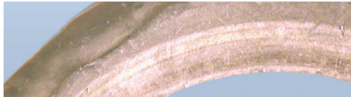
Abb. 5.10: Korrosion der metallischen Binderphase, gefolgt von starker Erosion bei einem Dichtring aus Wolframkarbid und einer metallischen Binderphase aus Kobalt
