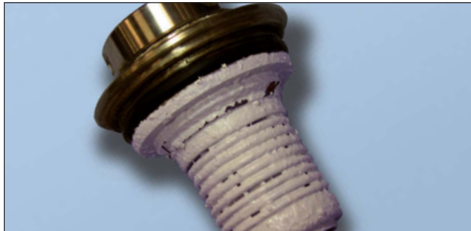
Abb. 5.7: Blockieren einer Gleitringdichtung mit Metallfaltensalz durch Kalkablagerungen
