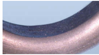
Abb. 5.17: Verschleiß am dynamisch belasteten O-Ring, wo die Dichtung die Welle berührt
