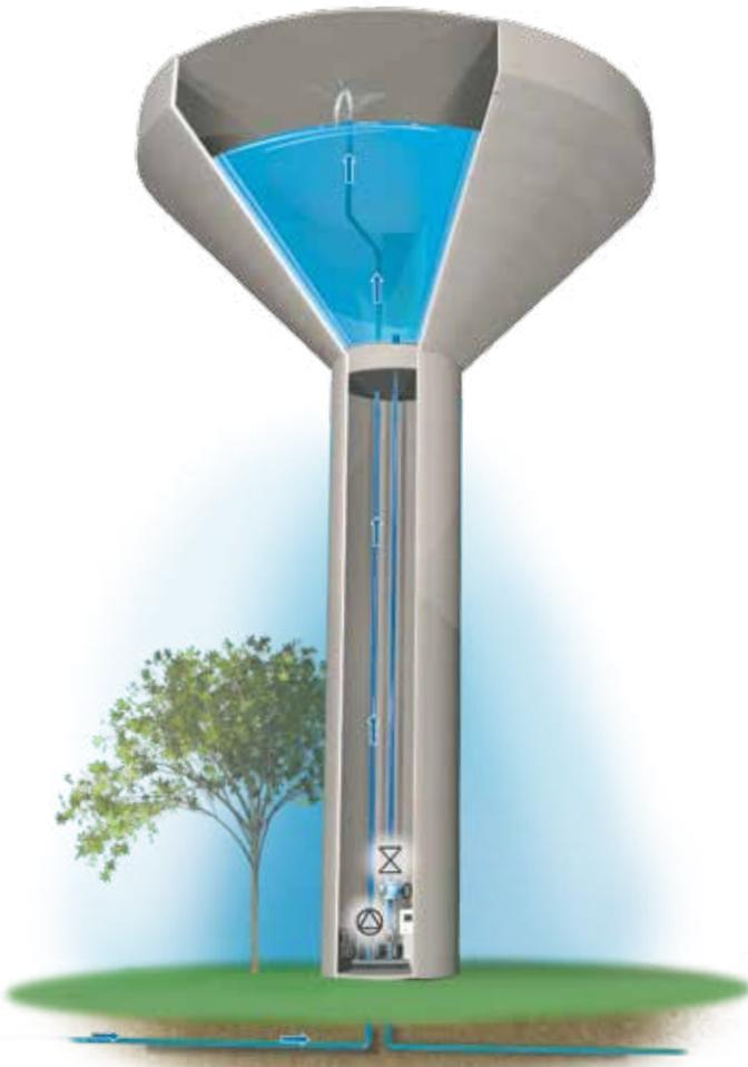
Wasserturm mit Druckerhöhungsanlage und Regelventil
